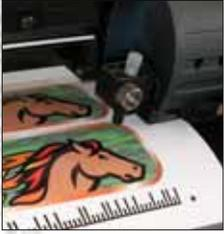
OPOS ist das zuverlässige **optische System** zum automatischen Konturschneiden für das Produzieren von Aufklebern. Es erhöht die Produktivität der Arbeitsläufe beim vielfachem Schneiden von Konturen.
